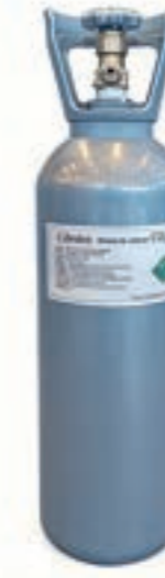
HBS1320-40 Cilindro de aço para CO2 - capacidade 4kg - 6,70L (vazio) com válvula e alça ISO9809-3
