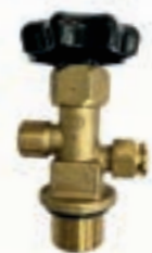
HBS1310-51 Válvula Topo p/ Cilindros de CO2, Entrada 1.1/8" 12UNF saída CGA320
